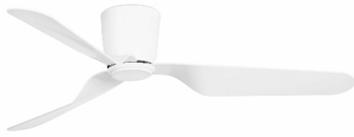
Ventilateur de plafond avec moteur DC idéal pour des pièces à partir de 17,6m<sup>2</sup>. Moteur en acier et pales blanches en acrylique, no réversibles. Actionné à l'aide d'une télécommande (incluse) de 6 vitesses réglables (50 - 76 - 99 - 127 - 151 - 175 rpm) correspondant aux consommations suivantes : 2 - 7 - 9 - 14 - 21 - 32w. Ce ventilateur dispose de la fonction inverse, vous pourrez donc l'utiliser en hiver. Kit d'éclairage optionnel LED non incluse: Ref. 33471K.
